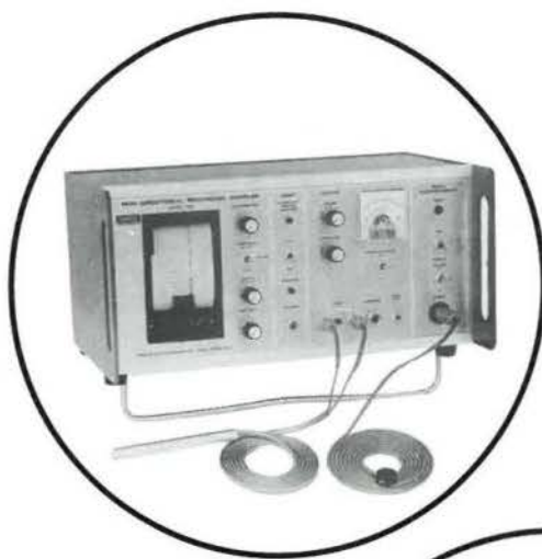
Doppler Parks no direccional, equipado con fotopletismógrafo y registro impreso.
