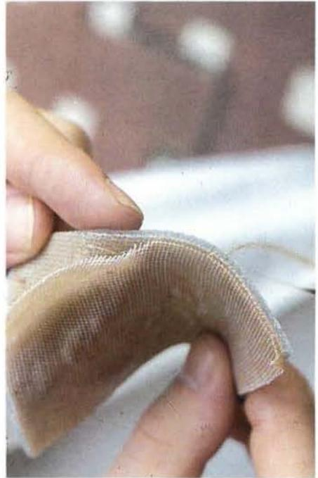
Fig. 22 Resinas fusionadas al calor y vacío.
