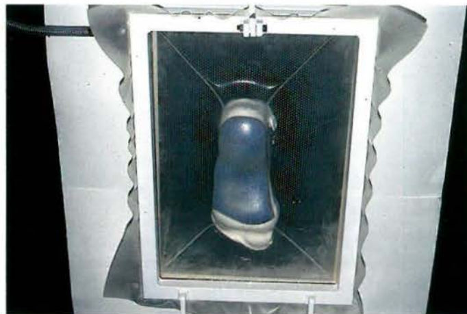
Fig. 9 Confección del soporte al calor y vacío.
