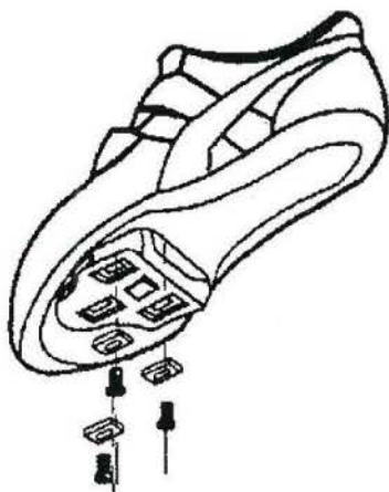
Fig. 3.- Calzado ciclista y calas. Sistema de fijación.
