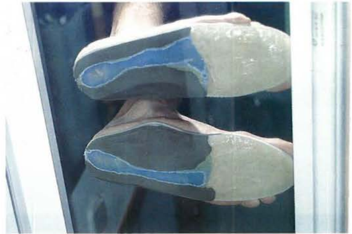
Fig. 49.- Se decidió en la revisión añadir un elemento estabilizador central de refuerzo.
