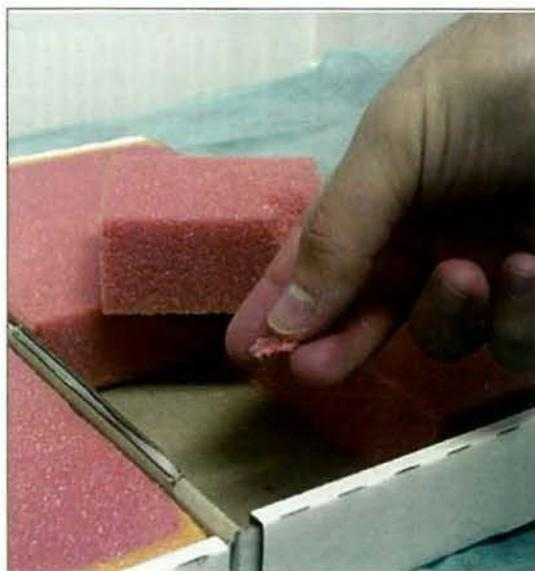
Figura 2. "La espuma fenólica es poliestireno, con características de plasticidad y fragilidad."
