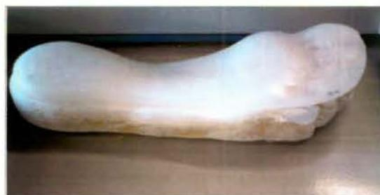
Imagen 9: Armazón de Polipropileno de 3 mm.
